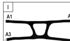
Platzieren Sie den Kopfgurt mit den Klettverschlüssen nach unten auf einen flachen Untergrund.
